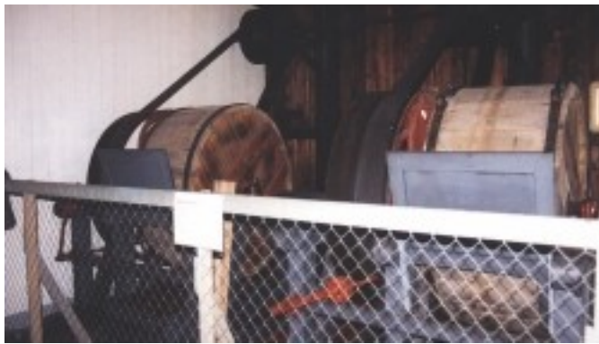
In Trommelanlagen wurde das Pulver zu Kügelchen geformt.
